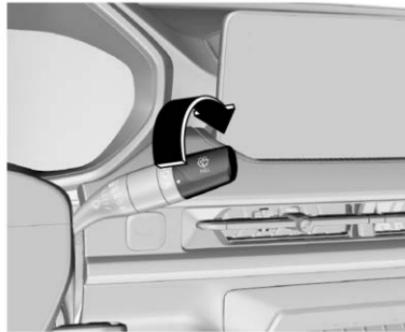
Para usar el limpiaparabrisas trasero, gire la ignición a la posición "ON" (encendido) y luego gire la perilla del interruptor del limpiaparabrisas y lavaparabrisas trasero a
