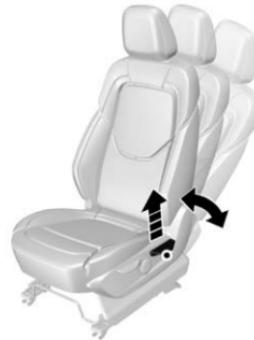
Jale hacia arriba la palanca y ajuste el ángulo de inclinación del respaldo a una posición adecuada y después suelte la palanca. No se apoye en el respaldo del asiento mientras lo ajusta. Después de ajustar el respaldo, apóyese sobre él para asegurarse que esté bloqueado en su lugar.
