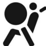
La luz de advertencia de la bolsa de aire se ilumina cuando se enciende la ignición y se apaga varios segundos después. Esto indica que tanto el foco de la luz de advertencia como el sistema de bolsa de aire pueden funcionar normalmente.
