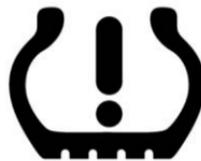
La luz de advertencia se ilumina después que se enciende la ignición y se apaga varios segundos después. Esto indica que la luz de advertencia puede funcionar normalmente.
