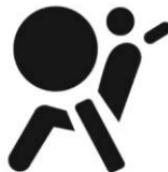
En el tablero de instrumentos, hay un indicador de bolsa de aire que muestra el símbolo de forma de la bolsa de aire. El sistema verificará si el sistema del circuito de la bolsa de aire tiene una falla y dará el aviso correspondiente a través del indicador.
