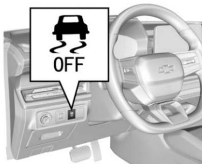
Presione el interruptor ESC OFF, y la luz ESC OFF en el grupo de instrumentos se ilumina y algunas funciones ESC se desactivan. Presione nuevamente el interruptor ESC, la función ESC se activa nuevamente y la luz ESC OFF en el grupo de instrumentos se apaga.
