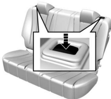
Primero dé la vuelta al cojín, luego jale la correa del respaldo para desbloquear el respaldo y después doble el respaldo hacia adelante hasta que quede plano. Ambos respaldos se pueden plegar y colocar planos. Opere en orden inverso cuando coloque en su posición original. Intente sacudir el respaldo y el cojín para asegurarse que estén bloqueados.
