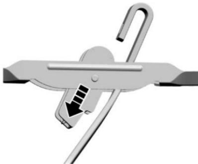
Como se muestra, ajuste la hija del limpiador en un ángulo perpendicular al brazo del limpiador, y después presione la hoja en la dirección de la flecha para separar la hoja del brazo del limpiador.
