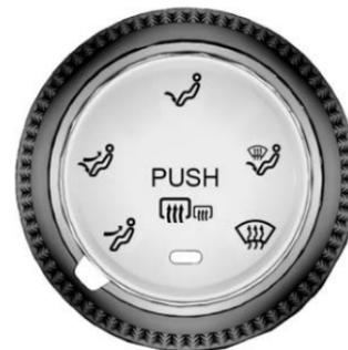
Ajuste la perilla de distribución de aire al modo deseado para que el aire fluya en la dirección deseada.
