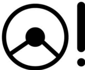
Esta luz de advertencia se encenderá inmediatamente cuando se encienda la ignición. Indica que el sistema está realizando una inspección automática y que el foco de la luz de advertencia puede funcionar normalmente. La luz de advertencia se apaga varios segundos después.
