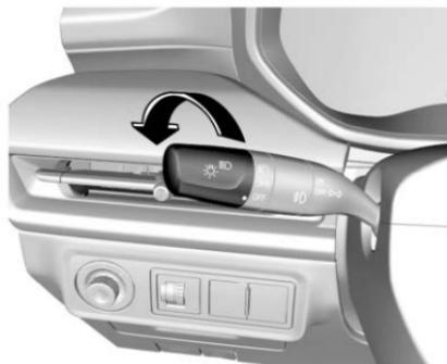
Para encender o apagar el faro, la luz trasera y a luz de estacionamiento, gire el extremo de la palanca de control del interruptor de combinación.
