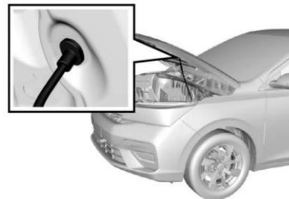
3. Separe la varilla de soporte del cofre del motor de la abrazadera de fijación. Levante la varilla de apoyo e inserte firmemente el extremo libre en la ranura del cofre del motor.
