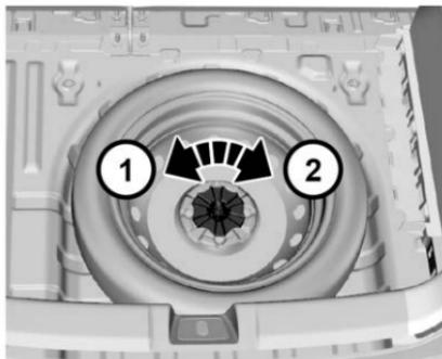
1. Abra la puerta trasera y retire el piso del compartimiento de equipaje. El gancho del piso se puede colgar en la bisagra del lado derecho de la puerta trasera.
