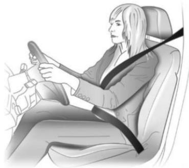
El cinturón de seguridad está diseñado para un solo pasajero. No es aplicable a un pasajero menor de 12 años o menor de 150 cm de altura. Revise todas las partes del sistema del cinturón de seguridad en busca de daños y funcionamiento anormal regularmente. Reemplace las partes y componentes dañados. Para reemplazar o reparar un cinturón de seguridad, consulte a su distribuidor.
