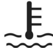
La luz de advertencia de temperatura del refrigerante del motor se ilumina cuando se enciende la ignición, y se apaga varios segundos después. Indica que tanto el sistema como el foco indicador funcionan normalmente.
