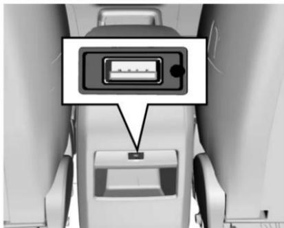
Si el vehículo está equipado con un tomacorriente USB para accesorios trasero (5 V), está ubicado en la parte trasera de la consola. Se puede usar para cargar teléfonos celulares. El tomacorriente no está disponible si la ignición está apagada.
