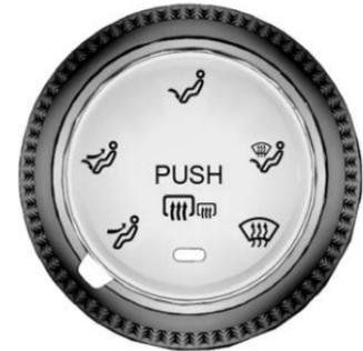
Para encender el desempañador, primero encienda la ignición y luego presione el botón del desempañador del parabrisas trasero. El indicador debajo del botón se ilumina. Presione nuevamente para apagar el desempañador y el indicador debajo del botón se apagará.
