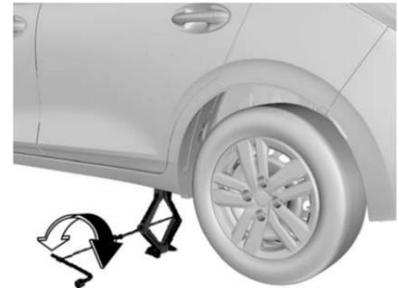
5. Gire el estribo del gato en sentido de las manecillas del reloj para permitir que el gato suba lentamente y asegúrese que la cabeza del gato esté firmemente presionada en la posición de elevación. No intente levantar el vehículo antes de colocar el gato en una posición adecuada. El gato debe estar firmemente sujeto entre el vehículo y el suelo.
