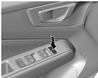
El botón de bloqueo de la ventana eléctrica se puede presionar para bloquear las ventanas traseras y el interruptor de la ventana del pasajero delantero. Cuando se presiona el botón, las ventanas traseras y la ventana del lado del pasajero delantero sólo se pueden controlar mediante el tablero de control de la ventana en el lado del conductor. Presione de nuevo para desbloquear.
