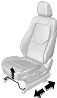
Jale hacia arriba la palanca de ajuste en la parte inferior delantera del asiento para ajustar el asiento hacia adelante o hacia atrás, y suelte la palanca después que el asiento esté ajustado en la posición adecuada.
