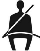
La luz de advertencia del cinturón de seguridad se ilumina si el conductor no se abrocha adecuadamente el cinturón de seguridad después de que se enciende la ignición. Después de esto, las siguientes circunstancias aparecerán a menos que el conductor se abroche el cinturón de seguridad adecuadamente:
