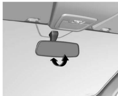
Los espejos retrovisores interiores se pueden ajustar manualmente a un ángulo de visión apropiado.
