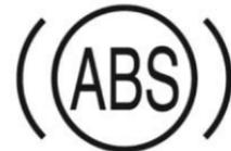
La luz de advertencia del ABS se encenderá inmediatamente cuando se encienda la ignición. Indica que el sistema está realizando una inspección automática y que el foco de la luz de advertencia puede funcionar normalmente. La luz de advertencia se apaga varios segundos después.
