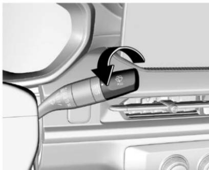
Cuando el faro está en luz baja o la luz antiniebla delantera está encendida, gire la perilla de control de la luz antiniebla trasera a la posición
