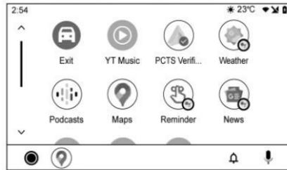
Para usar Android Auto, conecte un cable USB de teléfono compatible en el puerto de datos USB del vehículo y al smartphone Android. Para un mejor desempeño, utilice el cable USB del dispositivo provisto en fábrica. A continuación, toque Android Auto en la página de inicio del sistema de infoentretenimiento. Si la conexión tiene éxito, se muestra el menú Android Auto.
