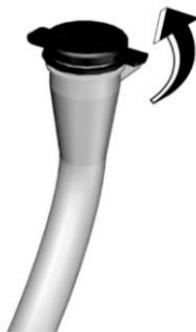
Antes de conducir, verifique el volumen de líquido de lavado en el depósito de líquido de lavado de parabrisas.
