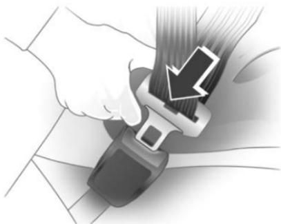
Saque el cinturón de seguridad del retractor, guíelo alrededor del cuerpo sin girarlo e inserte la lengüeta de bloqueo en la hebilla para asegurarlo. Al conducir, jale con fuerza del cinturón de hombro para ajustar la tensión del cinturón de cadera.
