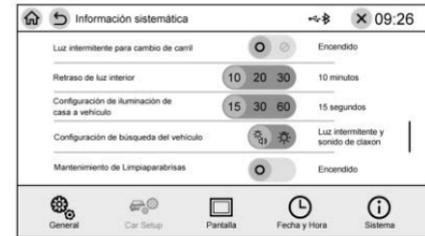
Para abrir el menú de Configuración del vehículo, toque Configuración del vehículo.
