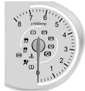
Muestra las revoluciones del cigüeñal del motor por minuto.
